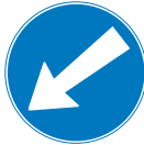
2.35 Hindernis links umfahren
