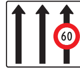
4.77.1 Anzeige von Fahrstreifen mit Beschränkungen (Beispiel)
