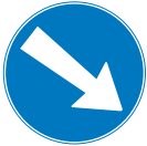
2.34 Hindernis rechts umfahren
